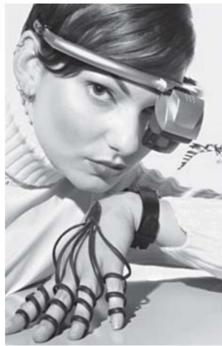
◇입는 컴퓨터 HMD(머리에 착용하면 가상의 모니터를 통해 화상을 보는 장치)와 동작 감지 센서로 구성된 입는 컴퓨터(wearable computer)를 모델이 직접 착용한 모습.
