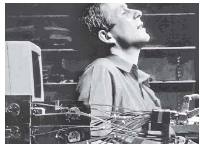
◇로봇팔 테스트 케빈 워릭 교수가 몸에 이식한 칩을 이용, 자신의 팔에 전선으로 연결된 로봇 팔을 자신의 의사에 따라 직접 움직여 보이고 있다.
